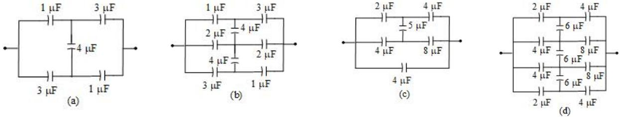
A-12 (a)  $\frac{11}{6} \mu F$  (b)  $\frac{11}{6} \mu F$  (c)  $8 \mu F$  (d)  $8 \mu F$
